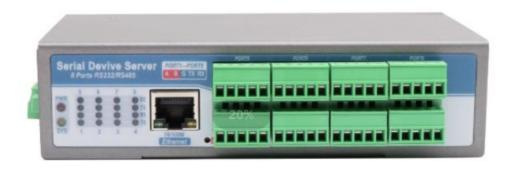
赛诺联克(SERIALLINK)SLK-S508D-DIN 导轨式串口服务器是将多路分散的, 低速的, 不同标准的串口设备转换成以太网进行集中管理, 主要连接的设备有温湿度, PLC 串口, 电力抄表等各种仪器仪表, 交换机路由器的 CONSOL 调试串口等。串口服务器支持多种工作模式, TCP Server、TCP Client 、UDP、Modbus RTU 转Modbus TCP Server等等,允许用户软件通过 TCP 客户端加端口号或者 Telnet 协议来访问串行设备,也支持虚拟串口的方式访问串行设备。 每路串口支持 TVS,ESD,磁隔离保护, 电源支持 DC12-28V,并具备抗浪涌保护,具备标准 35MM 导轨安装。 串口服务器还支持 SNMP V1,V2,V3 网管协议以及 TR069 电信级远程设备管理协议, 可以实现远程重启, 远程升级, 远程下发配置等功能。SERIALLINK 串口服务器产品已广泛应用在: 智能数字交通、智能电网、供应链自动化、生产工业自动化、交换机/路由器软件调试、交换机/路由器生产过程中的老化测试、机房环境监控等领域。
