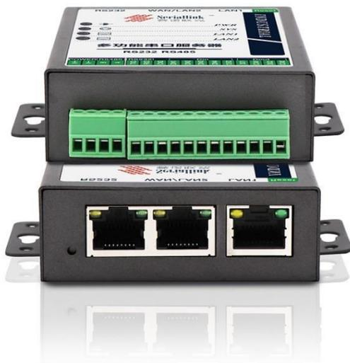
赛诺联克（SERIALLINK）SLK-S502 系列串口服务器是将多路分散的，低速的，不同标准的串口设备转换成以太网进行集中管理，安装虚拟串口之后可以实现对串口数据的远程读取。SLK-S502 系列串口服务器支持多种工作模式，其中 TCP 服务端模式、TCP 客户端 模式、UDP 模式、TCP/UDP Socket, Modbus RTU 转 Modbus TCP Server 等工作模式，允许用户软件通过 TCP 加端口号访问串行设备。另外，也支持虚拟串口的方式访问串行设备。赛诺联克（SERIALLINK）SLK-S502 支持通过浏览器 或 Telnet 终端方便快捷地手动配置 IP 地址。同时，用户也可以通过简单易用的 Windows 管理软件自动搜索局域网内的串口服务器设备，并进行远程配置管理和工作状态监测等应用。
